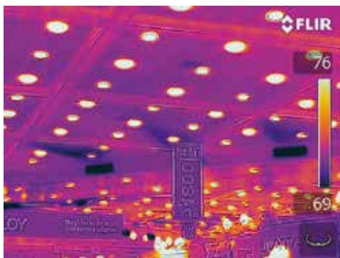
Le mode MSX ® permet de voir plus de détails sur l'image thermique
